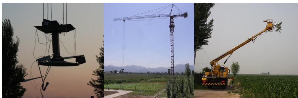
图1 光学反射（光谱仪）和微波散射（微波散射计）、红外辐射（热像仪）和微波辐射（微波辐射计）协同定点观测
